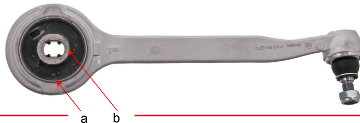
Фиг. 3: Позиция за монтаж на хидротампона
