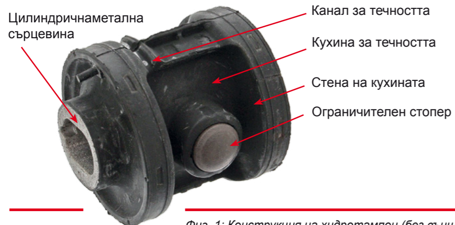
Фиг. 1: Конструкция на хидротампон (без външната метална черупка)
